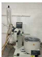
Figura 3. Montaje del rotavapor.
