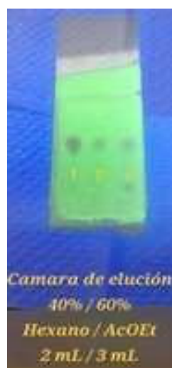
Figura 3. Comparación de la sulfanilamida sintetizada con un estándar de sulfanilamida, y el cloruro de N -acetilsulfanililo.
